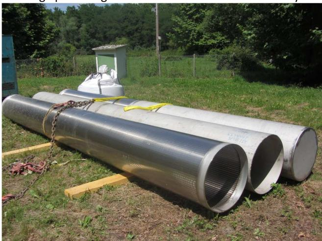
↑ Détail du tubage intérieur du puits tubage crépiné et lisse.
