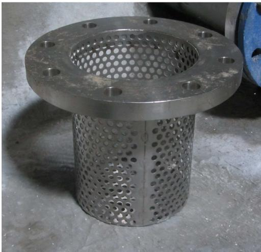
↑ Nouvelle crépine inox avant pose, réservoir semi-enterré de Morlaàs-Haute Vue.
