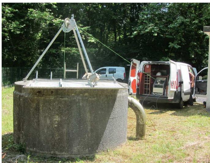
↑ Diagraphies du puits P17 avant intervention d'air-pulsé
