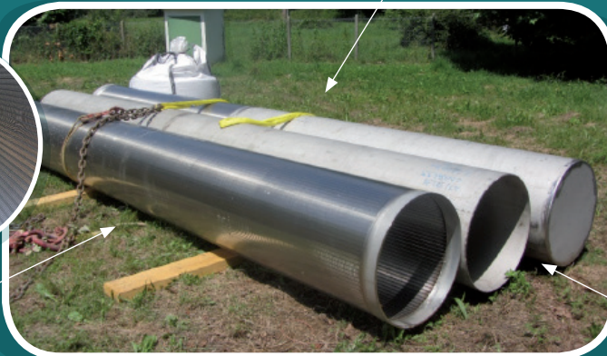
Tube crépiné et lisse avec sabot (bas)
